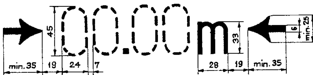
Знак за разстоянието между централните оси и разстоянието между осите на талигите
