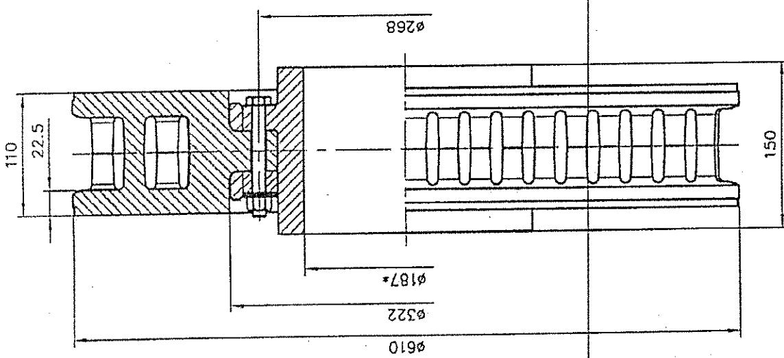
Забележка: Допуска се допустима разлика на отвора на гладнината ( $\phi 187*$ ) да се уточни при доставката на дисковете
