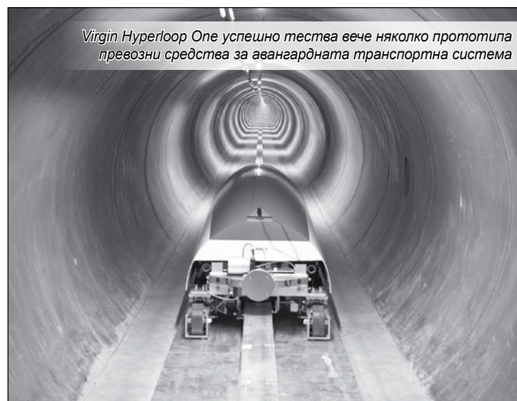
Концепцията Hyperloop предвижда трасета във вид на тръби с вакуум, в които на принципа на магнитната левитация да се движат транспортни капсули
