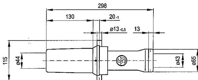
**ZH550-KD-DL-Vx-Sy-B-P** Розетка межвагонного соединения, крышка в длинном исполнении
