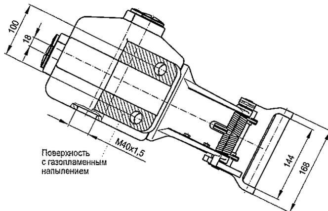
Поверхность с газопламенным напылением
